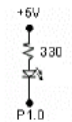
วงจรที่ใช้ทดสอบการดาวน์โหลด
